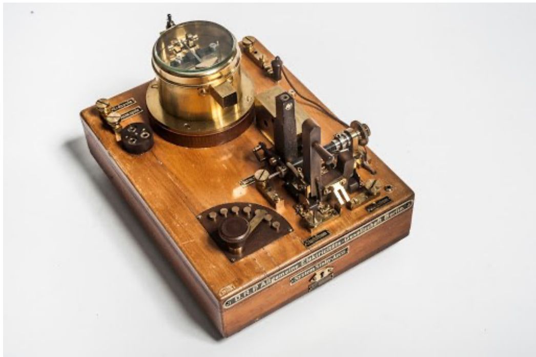
Рис. 3. Радіоприймач системи Слабі–Арко AEG, 1899 [25]
